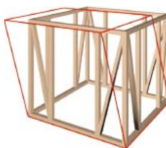
一般的な在来工法 (筋交い補強)
